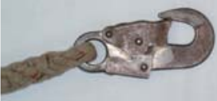
Bild 5-11: Stark korrodiertes Verbindungsmittel
