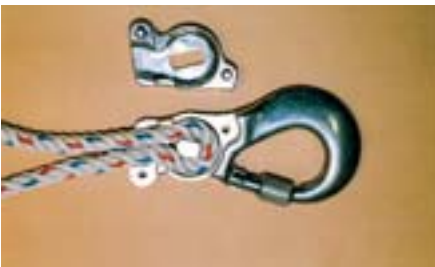
Bild 2-9: Verbindungsmittel mit Labyrinth, Falldämpfergehäuse offen
