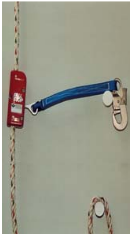
Bild 2-33: Mitlaufendes Auffanggerät (mit integriertem Falldämpfer)
