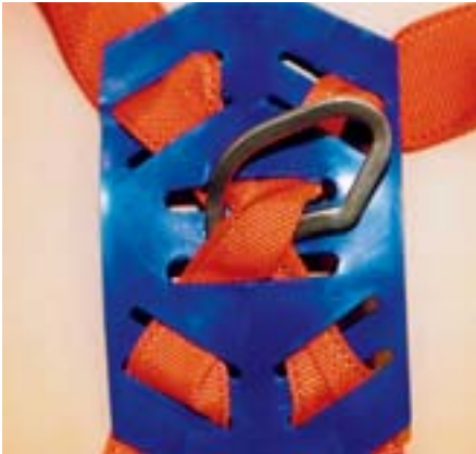
Bild 5-5: Beschädigung am Gurtmaterial
