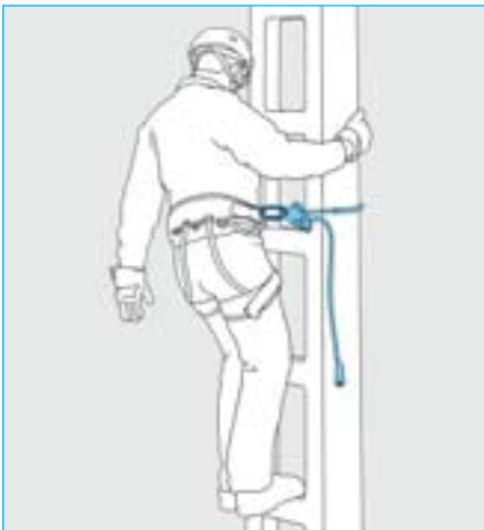
Bild 2-1: Haltegurt mit in der Länge verstellbarem Verbindungsmittel
