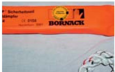
Bild 5-2: Kennzeichnung der Sachkundigenprüfung
