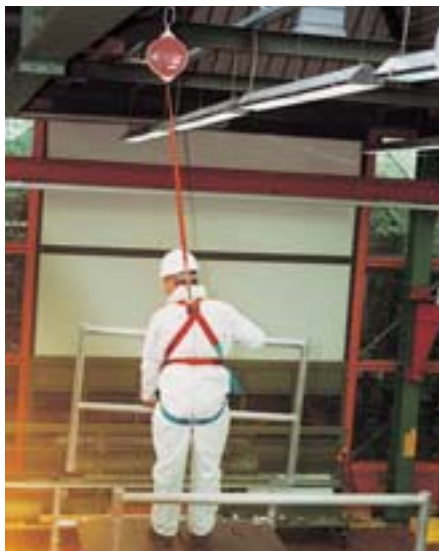
Bild 2-24: Höhensicherungsgerät im Einsatz
