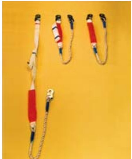
Bild 2-10: Bandfalldämpfer unbenutzt und beansprucht
