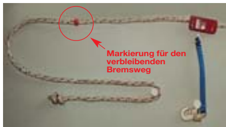
Bild 2-31: Begrenzung Bremsstrecke – Falldämpfer
