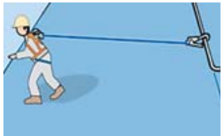
Bild 2-36: Person mit Rückhaltesystem
