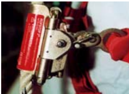
Bild 2-32: Kennzeichnung am mitlaufenden Auffanggerät auf Chemiefaserseil
